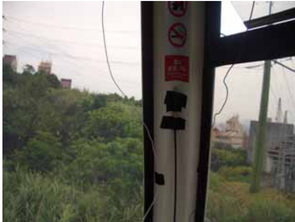
麥克風(車廂內) 量測乘客感受之噪音
