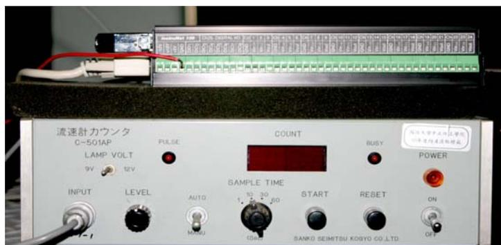
圖 4-8 螺槳式流速計與流速記錄器
