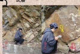
惠蓀林場達見砂岩層露頭Schmidt錘壓力強度量測
