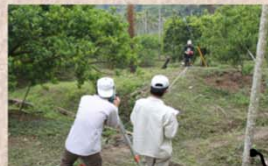
苗栗鯉魚潭集水區地電阻剖面影像法測線高程測量
