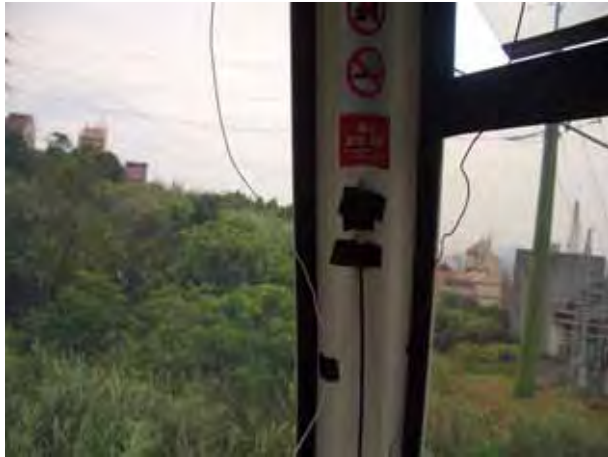
麥克風(車廂內) 量測乘客感受之噪音
