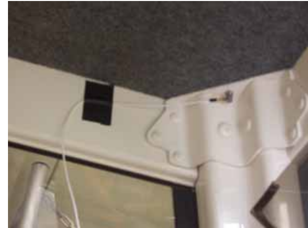
加速規(車廂框架) 量測纜繩傳遞至車體之振動
